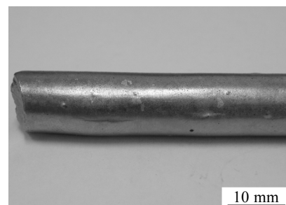
图 5 1550 °C 微波烧结 45 min 棒坯的表面形貌
